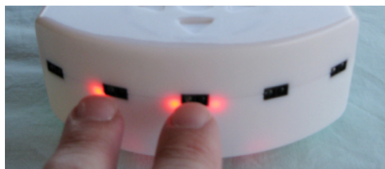
FIGURE 4.1 – L'avant de Thymio. Deux doigts sont détectés par les capteurs avant.
